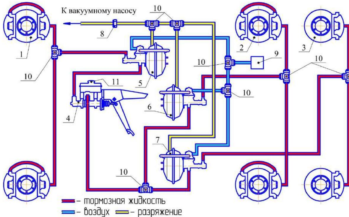
Рис. 6.17 Схема гидропривода тормозов:
