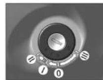
Рис. 5.8 Положения ключа выключателя зажигания, стартера и противоугонного устройства
