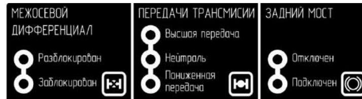
Рис. 6.5 Схема управления раздаточными коробками
