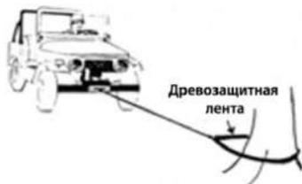
Рис. 19.2 Наиболее распространенный способ, обратите внимание, что в том случае, когда в качестве якоря используется ствол дерева, применяется древозащитная лента. Во избежание нанесения ущерба живой природе не пользуйтесь тросом или цепью. К тому же, трос нельзя обматывать петлей вокруг якоря, поскольку тем самым значительно уменьшается прочность троса на разрыв
