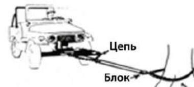
Рис. 19.4 В основном то же, что на рис. 19.3. Цепь с распределителем помогает равномерно распределить нагрузку по составным частям автомобиля
