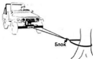
Рис. 19.3 Использование блока дает механическое усилие 2:1. К тому же вдвое уменьшается нагрузка на трос и лебедку. Соответственно, мотор будет крутить быстрее и с меньшим потреблением энергии. Можно работать с длинным тросом и не бояться перегрева мотора
