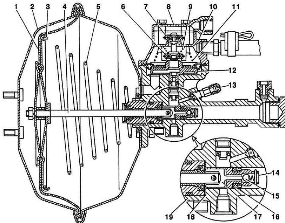
Рис. 6.19 Гидровакуумный усилитель
