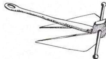
Рис. 19.10 Специальный якорь. В качестве такового лучше всего подходит лодочный якорь. Десятикилограммового якоря достаточно практически в любой почве и легко вытаскивается – достаточно проехать над ним. Для большей эффективности неплохо свести якоря вдвое ближе к стержню
