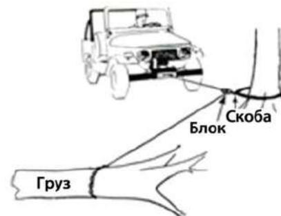
Рис. 19.5 Пример того, как с помощью блока можно менять направление тяги. Блок подсоединяется к древозащитной ленте с помощью соединительной скобы
