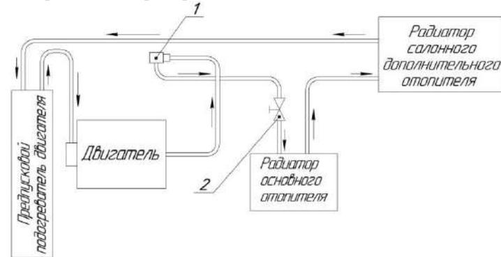
Рис. 6.22. Система отопления:
