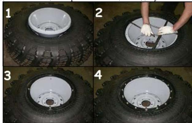
Рис. 10.4 Порядок монтажа шины ТРЭКОЛ
