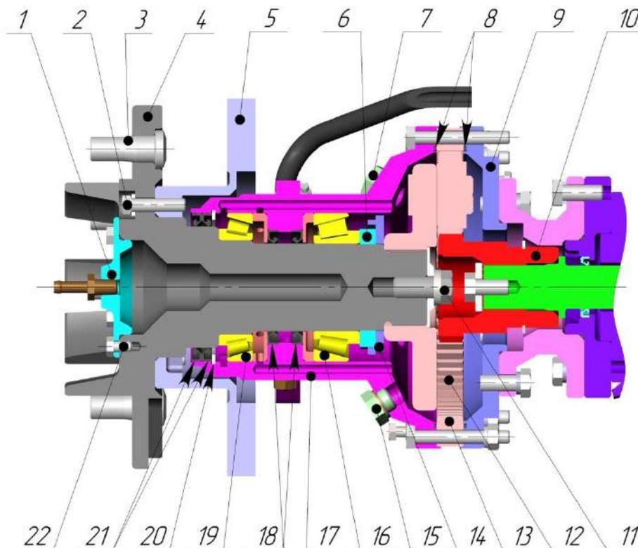
Рис. 6.12 Колесный редуктор
