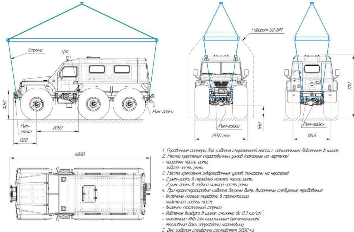
Рис. 14 Схема расположения строповочных и швартовочных узлов ВТС
